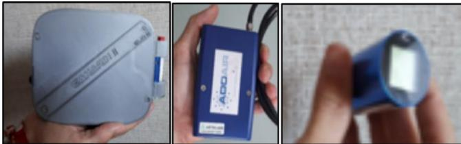
Figure : Dispositif des micro-capteurs (Canarin pour les PM, AE51 pour le BC et Cairsens pour le NO<sub>2</sub>) déployés pour le recueil de données dans les cohortes VGP et RECORD
